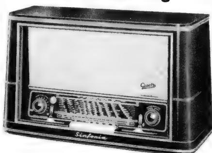
**Graetz-Sinfonia 4R.** Ein zusätzlicher Lautsprecher strahlt nach oben gegen einen Resonanzboden. Der Schall tritt durch die gitterverkleidete, um die Oberkante des Gehäuses herumlaufende schlitzförmige Öffnung nach allen Seiten radial aus. 8/12-Kreise, 438.- DM
