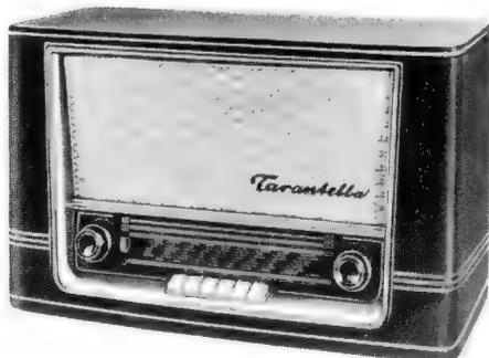
**Nora-Tarantella W949.** Zwei um 90° versetzte Hochtonlautsprecher auf der Frontseite strahlen die hohen Frequenzen horizontal und vertikal ab. Dies ergibt die angestrebte halbkugelförmige Klangverteilung aller Frequenzen. 6/9-Kreise, 278.- DM
